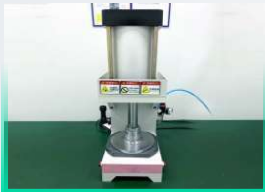
附着力检测仪：检测涂层附着力
