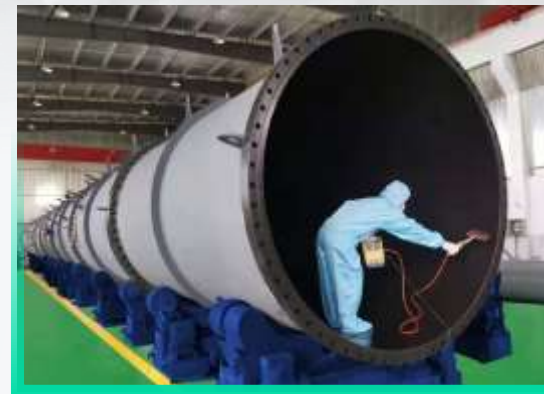
高温反应塔PFA烧结层检测
