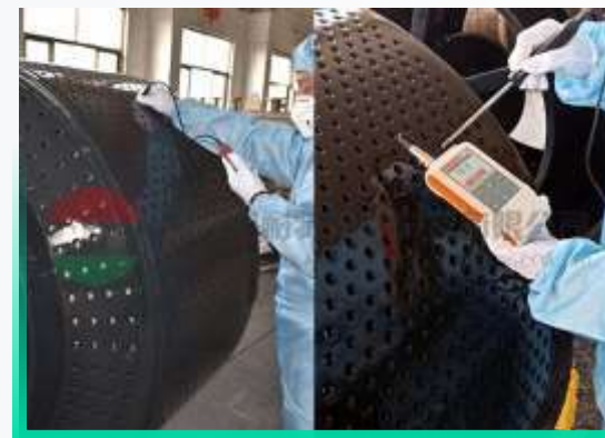
涂层表面及孔内膜厚检测
