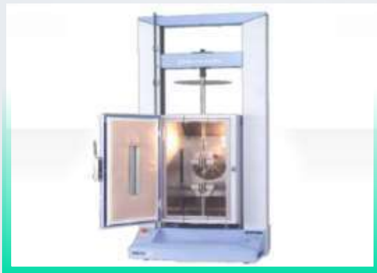
万能材料试验机： 用于板材衬后剥离强度的测试
