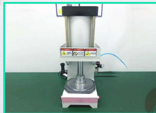
附着力检测仪：检测涂层附着力
