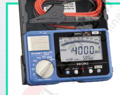
绝缘电阻测试仪： 在罐内满水和水压达到试验压力时，使用绝缘电阻测试仪，在500V的电压下，绝缘阻抗值显示>2000MΩ判定为合格，否则判定为不合格
