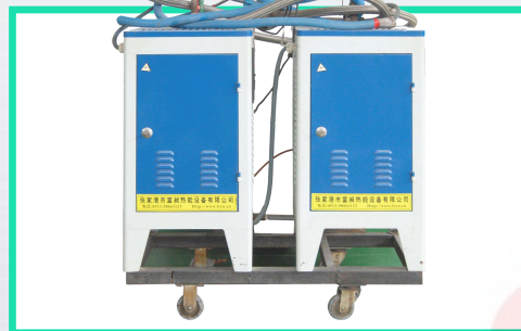
蒸汽锅炉： 用于内衬工艺蒸汽硫化
