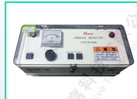
电火花测试仪： 主要针对板面的完好性测试
