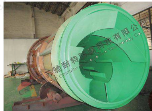
喷涂PTFE (窑炉施传干燥机)
